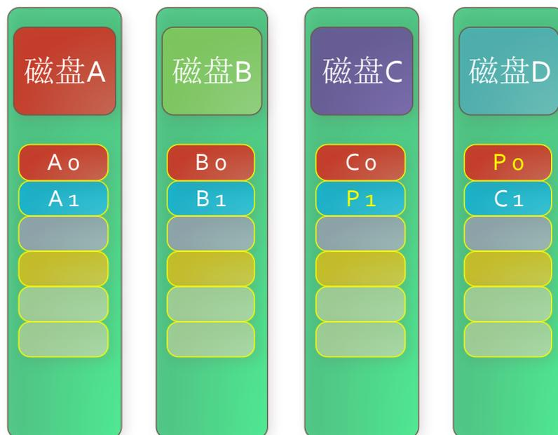
图 3-5 RAID5 结构图
